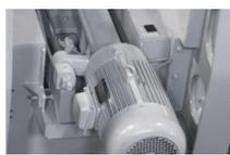
**Sistema inferior de Transmisión:** La mejor característica de la MJ164 es el diseño patentado de su motor inferior con acople directo, que permite el 100% de transmisión de la potencia a la sierra de corte, permitiendo trabajos de alta exigencia sin pérdidas en correas ni poleas, libre de mantenimiento.
