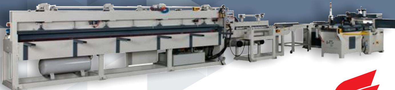
1. ART-T4 MESA ROTATIVA AUTOMÁTICA ( MEDIANTE BANDA TRANSPORTADORA ) 2. FJ-630RSC UNIDAD DE FRESADO DE FINGER CON ENCOLADOR INCLUIDO 3. TRT-RT1 MESA DE RODILLOS DE TRANSFERENCIA 4. FA6200-A PRENSA LONGITUDINAL DE 6200 MMS
